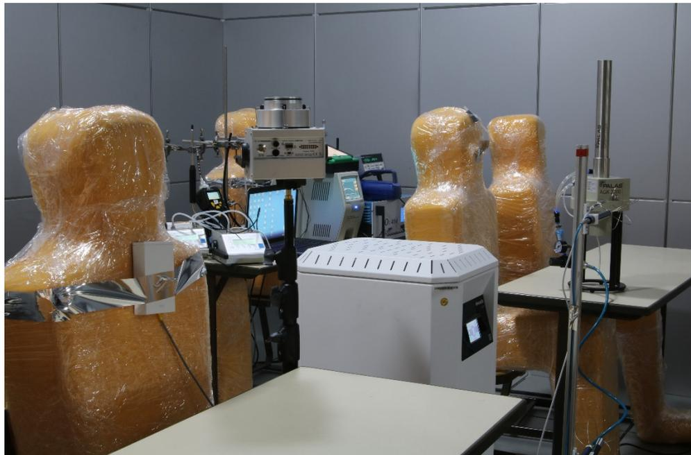
Bild 1: Aufbau R 150-Luftreinigungsgerät im IATC mit Aerosolgenerator (Dosiergerät), Sensortechnik und Luftkeimsammler.
